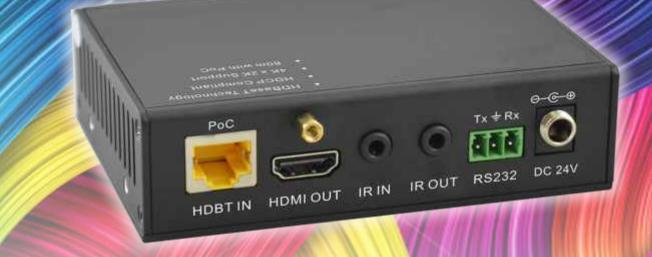
Extender HDBaseT per HDMI/IR/RS232 composto da trasmettitore (EXT-HDBT-70T) e ricevitore (EXT-HDBT-70R), L'EXT-HDBT-70 usa la tecnologia HDBaseT per trasmettere il segnale HDMI ad una distanza massima di 70m.
